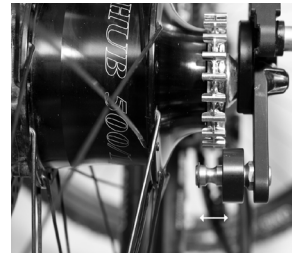
Figure 1: avant le démontage de la roue arrière, galet du Snubber poussé sur la droite
